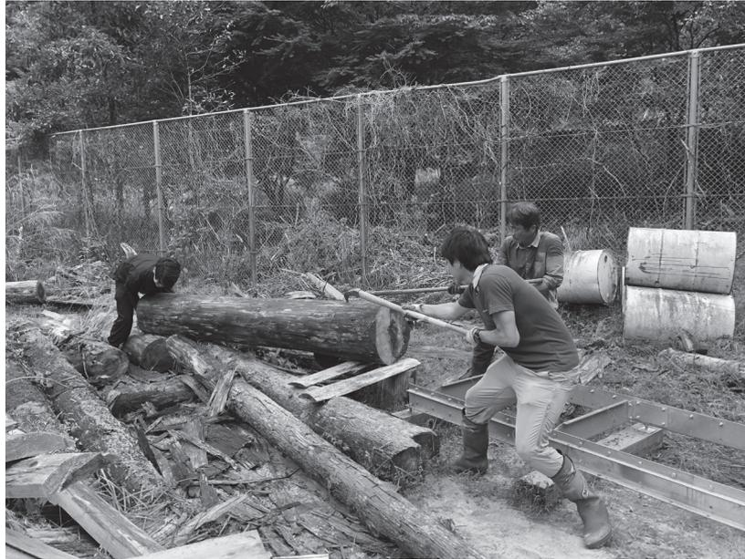
写真6 家屋補修に使う板材確保のためにスギの原木を製材する様子
